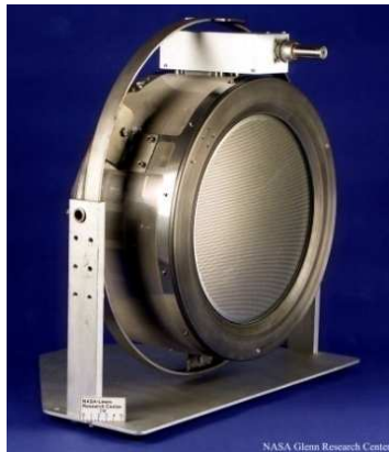
Moteur NSTAR de Boeing 90 mN / 3100 s 8,3 kg, 30 cm de diamètre P = 2,3 \text{ kW}
