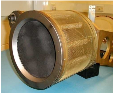
Moteur T6 de QinetiQ (configuration Kaufman) 200 mN / 4700 s 8kg, 30 cm de diamètre
