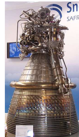
Moteur cryogénique Vulcain 2 960 kN au sol v_e = 4228 m/s
